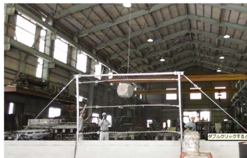
重錘衝突後の最大変形(正面)
